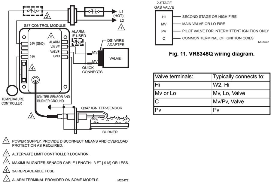
Fig. 11. VR8345Q wiring diagram.
