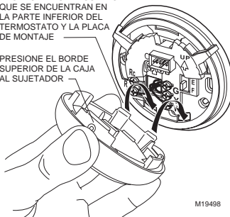
Figura 9. Montaje del termostato a la placa de fijación.
