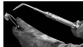
Figura 11. Encendido del gas combustible
