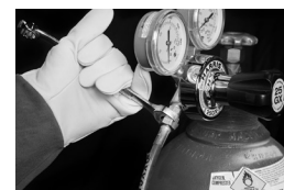
Figure 4. Raccordement du flexible au détendeur
