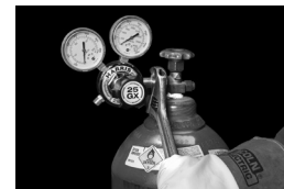
Figure 2. Raccordement du détendeur de l'oxygène
