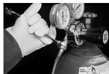
Figura 4. Acoplamiento de la manguera al regulador
