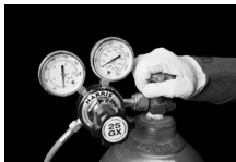
Figura 10. Apertura de la válvula de oxígeno
