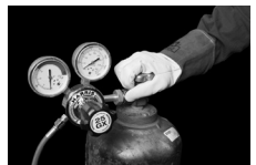
Figura 9. Apertura de la válvula de gas combustible del cilindro
