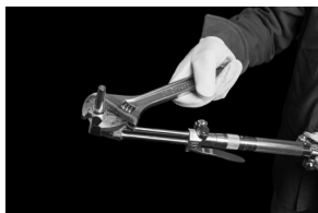
Figure 7. Montage du bec de découpage
