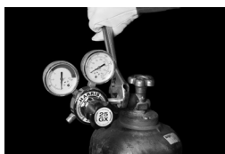
Figure 3. Raccordement du détendeur du gaz combustible
