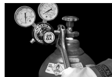
Figura 2. Acoplamiento del regulador de oxígeno
