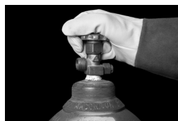
Figure 1. Ouverture du robinet de la bouteille d'oxygène
