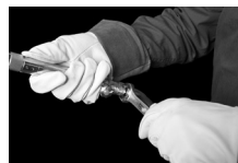
Figura 5. Acoplamiento de la manguera al soplete
