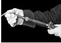
Figura 6. Instalación de la boquilla para soldar
