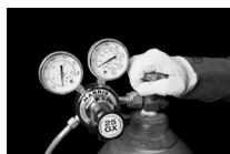
Figure 10. Ouverture du robinet d'oxygène
