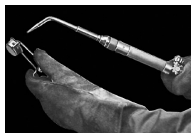
Figure 11. Allumage du gaz combustible
