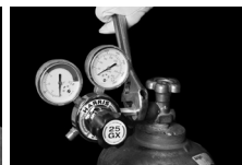
Figura 3. Acoplamiento del regulador de gas combustible
