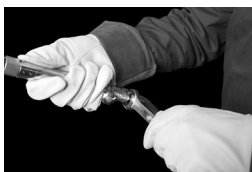
Figure 5. Raccordement du flexible au chalumeau
