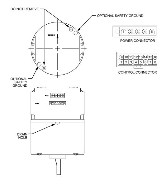
Fig. 15—FK4B, FK4C and FV4A ICM2 Motor
