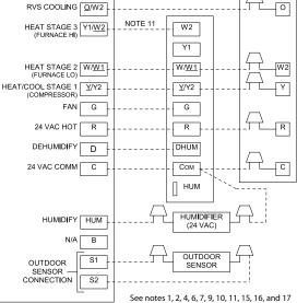
TWO-STAGE FURNACE SINGLE-SPEED HEAT PUMP
