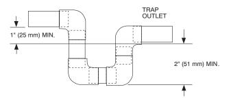
Fig. 9 - PVC Condensate Trap
