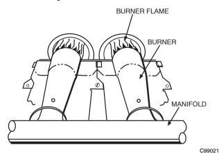
Fig. 8 - Monoport Burner
