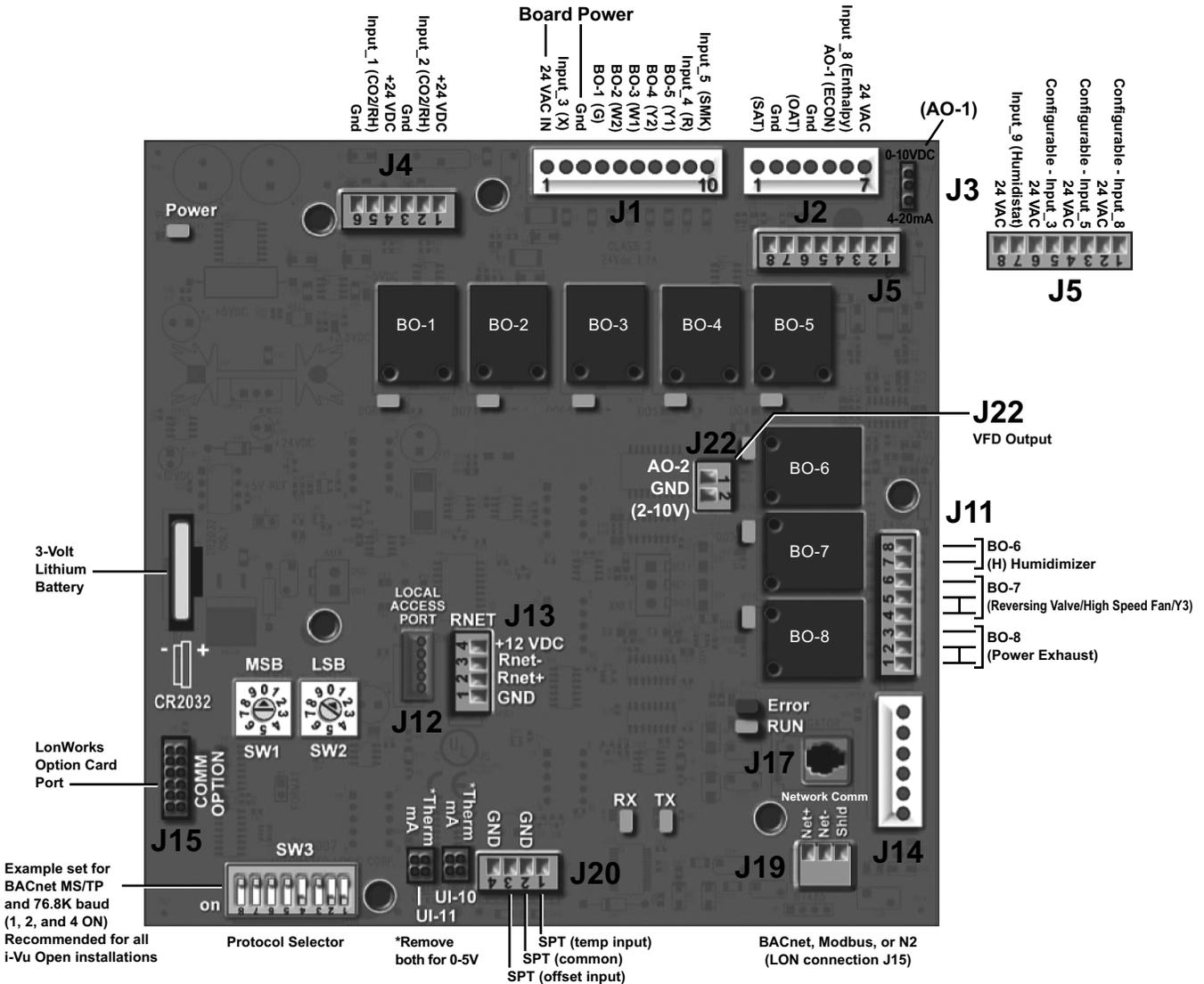
Fig. 60 - RTU Open Multi-Protocol Control Board
