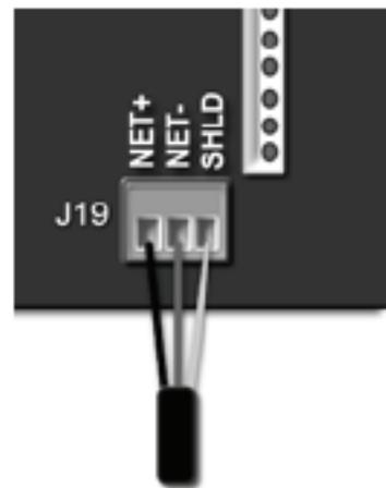
Fig. 72 - Network Wiring
