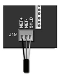
Fig. 72 - Network Wiring
