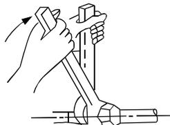
**Fig. 19 – Tighten Flare nut**
