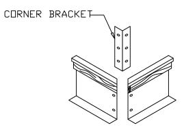
2 ARRANGE SIDES AND ENDS TOGETHER AT RIGHT ANGLES AS SHOWN.
