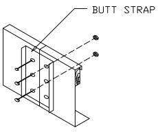
1 ARRANGE SIDES (3 & 4) TOGETHER TO MAKE ONE SIDE. BOLT TOGETHER USING BUTT STRAPS.
