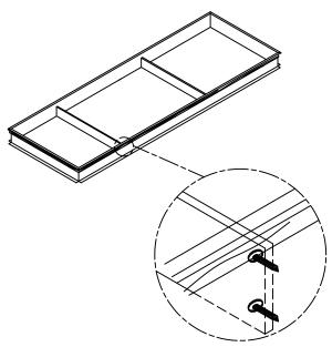
4 FASTEN CROSS SUPPORTS AS SHOWN USING THE 10-16×3/4" TEK SCREWS PROVIDED.
