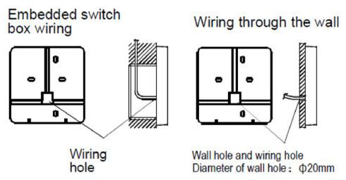
Fig. 9 - Wiring hole
